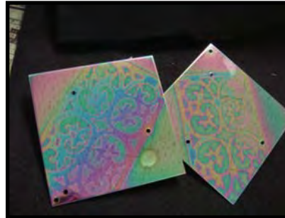
光干渉ナノ薄膜堆積技術 (東洋ステンレス研磨工業(株))
