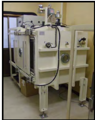
安心・安全・エコなマイクロ波減圧乾燥装置 (西光エンジニアリング(株))
