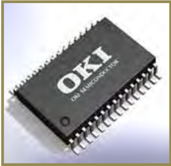
圧縮率を動的に可変できる高音質音声合成LSI(HQADPCM) (株)ラピスセミコンダクタ
